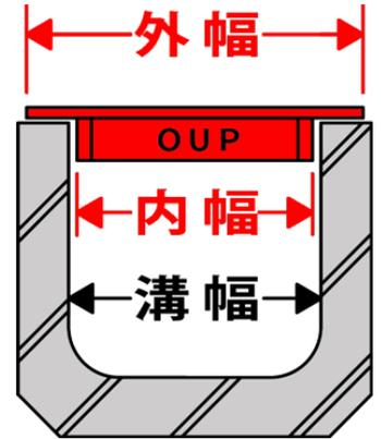
スチール製 U字溝用 縞鋼板みぞ蓋 OUP 縞鋼板+補強材FB4.5x25 材質:CP 亜鉛めっき仕上げ
