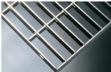
ステンレスグレーチングの主な用途は厨房、浴室等の屋内での使用が大部分です。その中でグレーチングは重い、施工が大変といったイメージから奥岡は一歩進んで従来のフラットバー(主部材)の厚みを標準タイプ4mmに加え、軽量・経済的な3mm材の製品を標準製作にしました。(材料比33%軽量)屋内向けなら荷重的にも十分対応が可能で安価にご使用頂けます。又、製品高さも従来のH20mmからH15mmより製作可能になり一層の軽量化を実現致しました。(材料比25%軽量)
