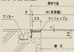
水抜き穴詳細図
